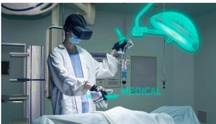
Le gant (ou exosquelette) Dexmo permet de toucher ou saisir des objets virtuels comme s'ils étaient réels grâce à de minuscules moteurs pouvant simuler par exemple l'impact sur un clavier. Une balle de baseball virtuelle semble ferme, un œuf fragile. Cela serait utile pour la CAO ou dans la formation aussi bien médicale qu'à la maintenance mécanique.
