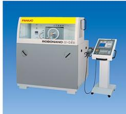
Appelée ROBONANO  $\alpha$ -0iB, c'est une fraiseuse en trois dimensions avec une précision nanométrique, ouvrant à de nouvelles applications (métamatériaux, etc).
