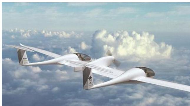
L'architecture originale de l'appareil est constituée de 2 fuselages placés de chaque côté de la nacelle moteur, le tout étant réuni par l'aile. Cette conception permettrait une capacité de chargement supérieure. Chacun des fuselages peut accueillir deux occupants. Ce projet zéro émission est destiné à servir d'*Electric air taxi* pour relier facilement des villes proches équipées d'aérodromes urbains, du fait du peu de nuisances (bruit).
