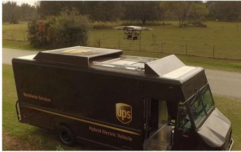
Le drone est un octocoptère capable d'emporter une charge de 4,5 kg et de voler en autonomie pendant 30 minutes. Il est installé sur une plateforme située sur le toit du camion dans lequel une trappe est ménagée pour laisser passer la nacelle de transport fixée sous l'appareil. Le chauffeur charge le colis directement depuis l'intérieur du fourgon et déclenche la livraison via un écran tactile sur le tableau de bord.
