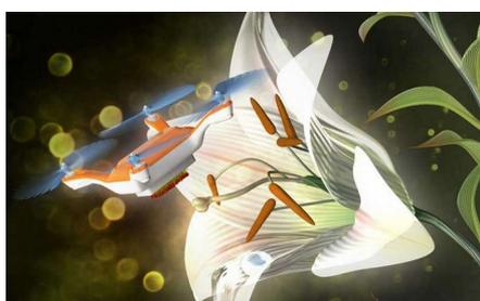
Une bande recouverte de crin de cheval a été collée sous l'appareil afin de reproduire les poils minuscules qui recouvrent les pattes des abeilles et leur servent à collecter le pollen. Cette brosse est enduite d'un gel ionique offrant une propriété adhésive proche de celle d'un post-it. Ensuite, le drone vole de sorte à effleurer la partie mâle puis la partie femelle de fleurs de lys japonais (rose et blanc) afin de collecter et redéposer le pollen.
