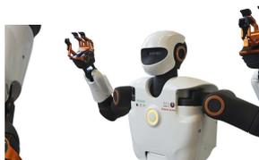
Le robot Pyrène est capable de se déplacer sur des terrains accidentés tout en portant des charges lourdes. Il peut aussi « *s'appuyer sur un mur ou saisir une rampe pour monter les escaliers* ». Il est surtout le premier robot du genre à pouvoir se servir d'outils pour effectuer des actions complexes, telles que visser ou percer un trou.
