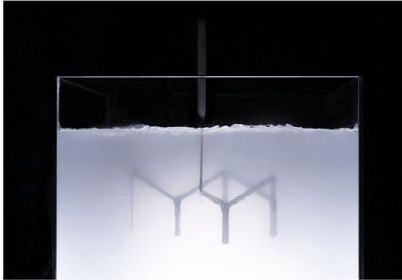
Le produit est formé de deux composants qui se solidifient quand ils entrent en contact. D'une part le gel dans le bac et d'autre part une seringue mobile injectant le second composant pour réaliser la forme voulue.
