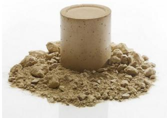
Le nom HP2A vient de '*High Performance Alkaline Activation*'. Dans le ciment Portland classique, la réaction est une recristallisation. Avec ce procédé d'activation alcaline, ce sont des liaisons covalentes dont la force est plus élevée qui se créent. La réaction moléculaire, qui se fait à froid, est naturelle et ne nécessite aucun produit venant de la pétrochimie. Cette technologie, issue des géopolymères, se résume en fait à recréer de la pierre à partir de l'argile.
