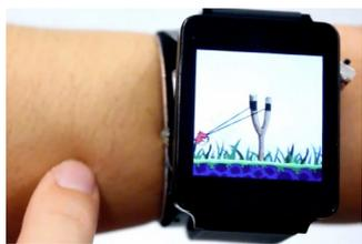
Une des principales limitations des smartwatches, c'est leur écran trop petit pour une interface tactile. La solution de SkinTrack consiste à détecter la position du doigt (par triangulation) à partir d'électrodes dans le bracelet, transformant ainsi la peau en touchpad avec une plus grande surface tactile.
