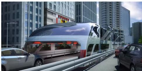
Lancé en 2010 par les autorités chinoises, le *straddling bus* est un concept de bus-tunnel électrique sur rails sous lequel les voitures peuvent circuler. Cet engin étonnant est présenté comme une alternative au métro. Il serait moins onéreux à déployer et permettrait d'éviter les embouteillages monstres qui paralysent les grandes villes du pays.
