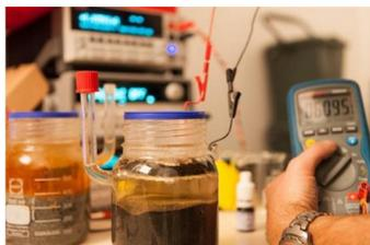
Simple et non polluante, la pile benthique produit de l'électricité à partir de sédiments et serait parfaitement adaptée à l'alimentation de capteurs océaniques.
