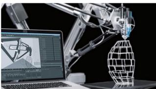
Elle imprime des tiges en résine qui sont solidifiées par de la lumière UV. La tête d'impression peut aussi les couper et les ajuster grâce à une scie miniature.
