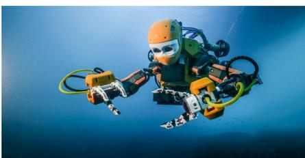
Il y a aussi ce [robot humanoïde sous-marin](#) destiné aux fouilles archéologiques en eaux profondes et dont les mains sont reliées à un système haptique qui permet à son pilote de ressentir avec précision ce que l'engin touche.
