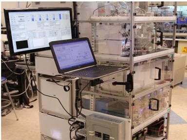
Cette machine compacte peut produire des milliers de doses de médicaments dans la journée - mettant les capacités d'une usine de médicaments dans un appareil de la taille d'un réfrigérateur.
