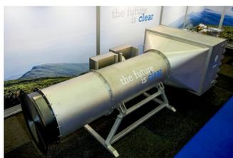
Ce filtre industriel en acier de 8m de long serait placé au-dessus de bâtiments, à proximité de zones industrielles. Capable d'aspirer de l'air dans un rayon de 300m, et jusqu'à une hauteur de 7 km, traitant 800.000 m<sup>3</sup> d'air par heure, il pourrait filtrer 100% des particules qui font de 2,5 à 10 microns et 95% des particules ultra-fines (ou nanoparticules) présentes dans l'air.
