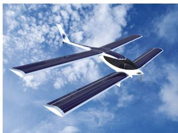
Le photovoltaïque peut couvrir jusqu'à 50% des besoins énergétiques de l'avion lors d'un vol en plein après-midi. Le reste de l'énergie électrique est fourni par une petite centrale thermique alimentée par des biocarburants.
