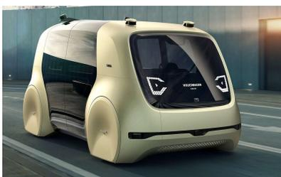
Sans pédales ni volant, elle s'apparente davantage à une navette de transport. Les sièges sont remplacés par deux banquettes qui se font face. Le pare-brise avant est en fait un écran Oled transparent qui peut se transformer en téléviseur ou en système d'affichage à réalité augmentée. Munie de caméras avec système de reconnaissance faciale, la voiture ouvre ses portes automatiquement à son propriétaire.
